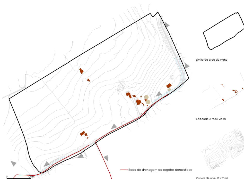
Figura 113. Rede de drenagem de esgotos domésticos
